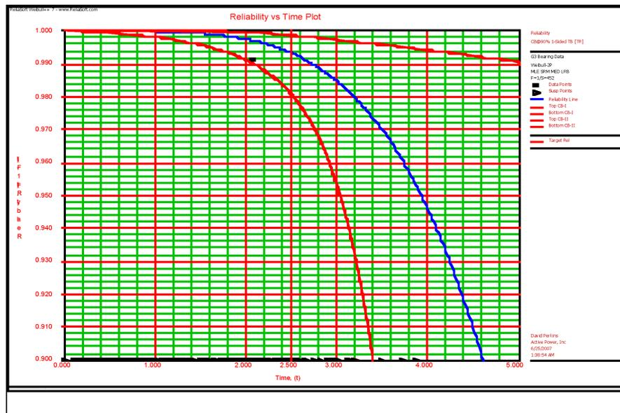
**FIGURE 9:** TIME DEPENDENT RELIABILITY OF THE ACTIVE POWER CLEANSOURCE UPS BALL BEARING SYSTEM SHOWING UPPER AND LOWER ONE-SIDE 90 PERCENT CONFIDENCE BOUNDS ON RELIABILITY
